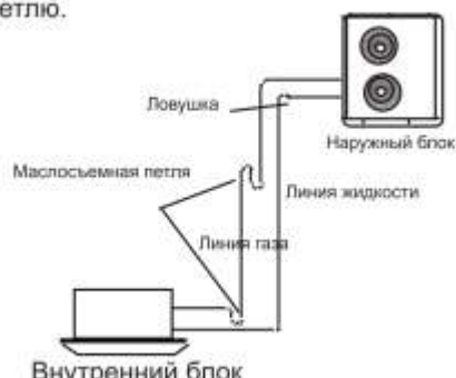
Внутренний блок установлен ниже наружных
