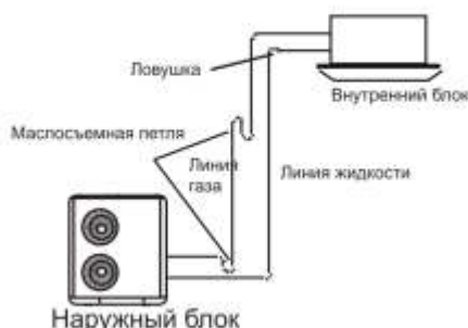
Внутренний блок установлен выше наружного.
